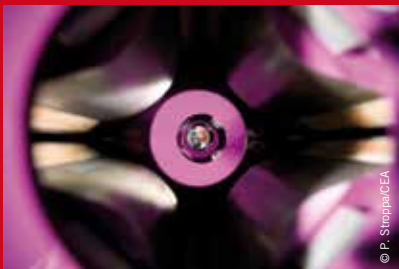
Quadrupôles de l'accélérateur linéaire Spiral2
