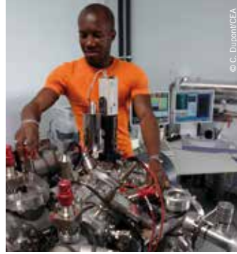
Spectromètre de masse permettant une mesure isotopique rapide sur un échantillon.
