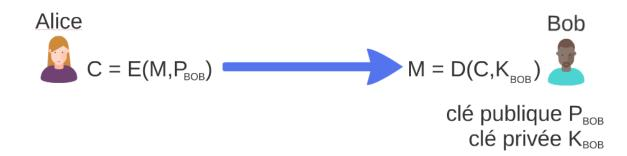
• Usage : on chiffre la clé symétrique avec les clés asymétriques et on utilise la clé symétrique ensuite pour chiffrer les messages
