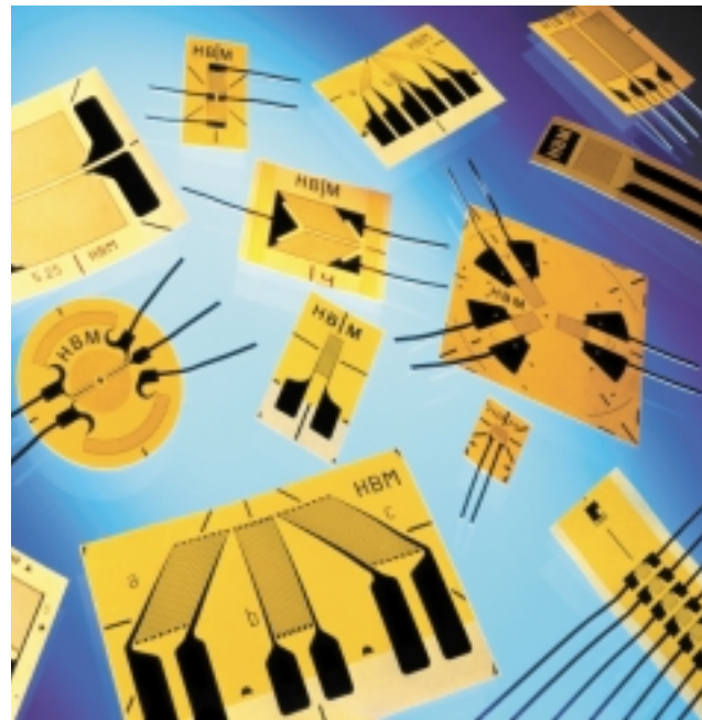
Les jauges de contraintes sont constituées d'un fil résistant très fin imprimé ou collé sur un support isolant. Elles traduisent en variation de résistance électrique la déformation du corps d'épreuve sur lequel elles sont collées.
