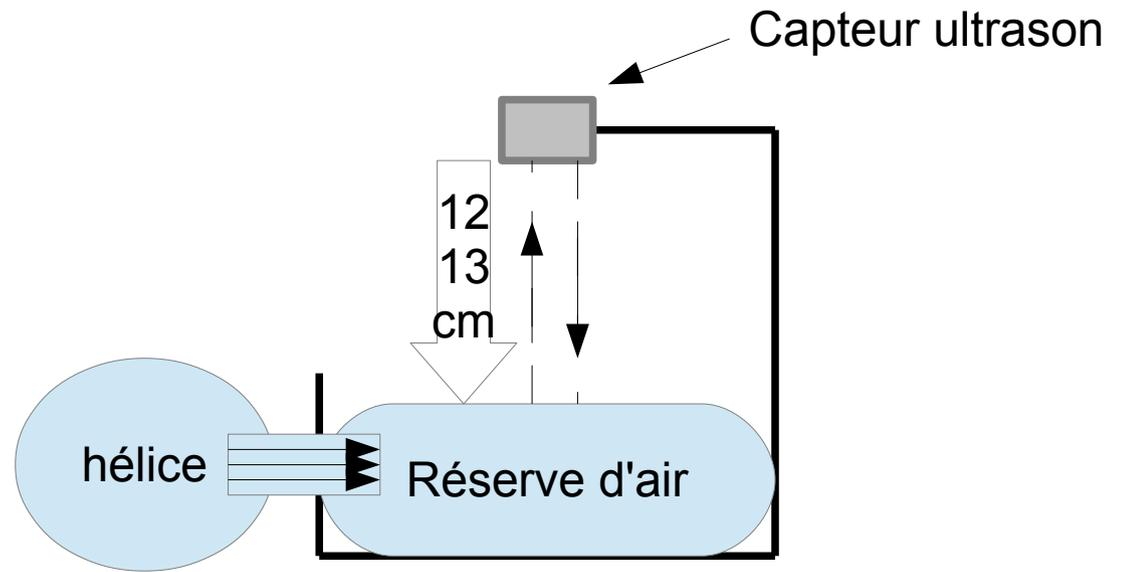
Quand la réserve a un volume d'air suffisant, pour une distance  $d = 12$  à  $13$  cm du capteur, l'hélice tourne moins vite. Lorsque la réserve passe à plus de  $13$  cm du capteur, l'hélice accélère pour la remplir. Il faut donc générer un signal pwm.
